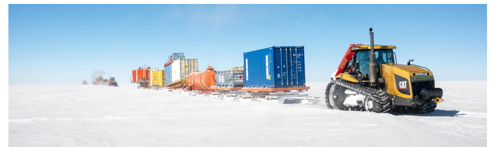
Persönliches Gepäck und Forschungsinstrumente werden mit Schneeraupenkonvois zur Station transportiert. Die zehnköpfige Besatzung fährt 14 Stunden am Tag für 10 Tage von der Antarktikküste 1100 km ins Landesinnere.
